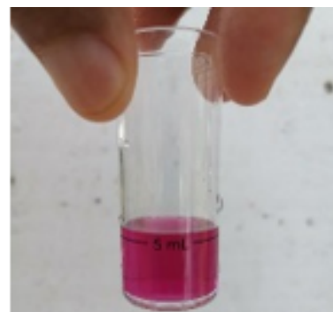
Fig. 10 – 2 ppm de chlore en fin de ligne
